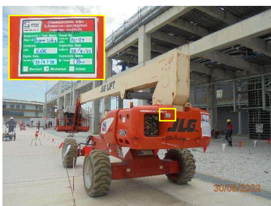
รูปที่ 2-28 สติกเกอร์แสดงการตรวจสอบสภาพอุปกรณ์ เครื่องมือ และเครื่องจักรประจำเดือน
